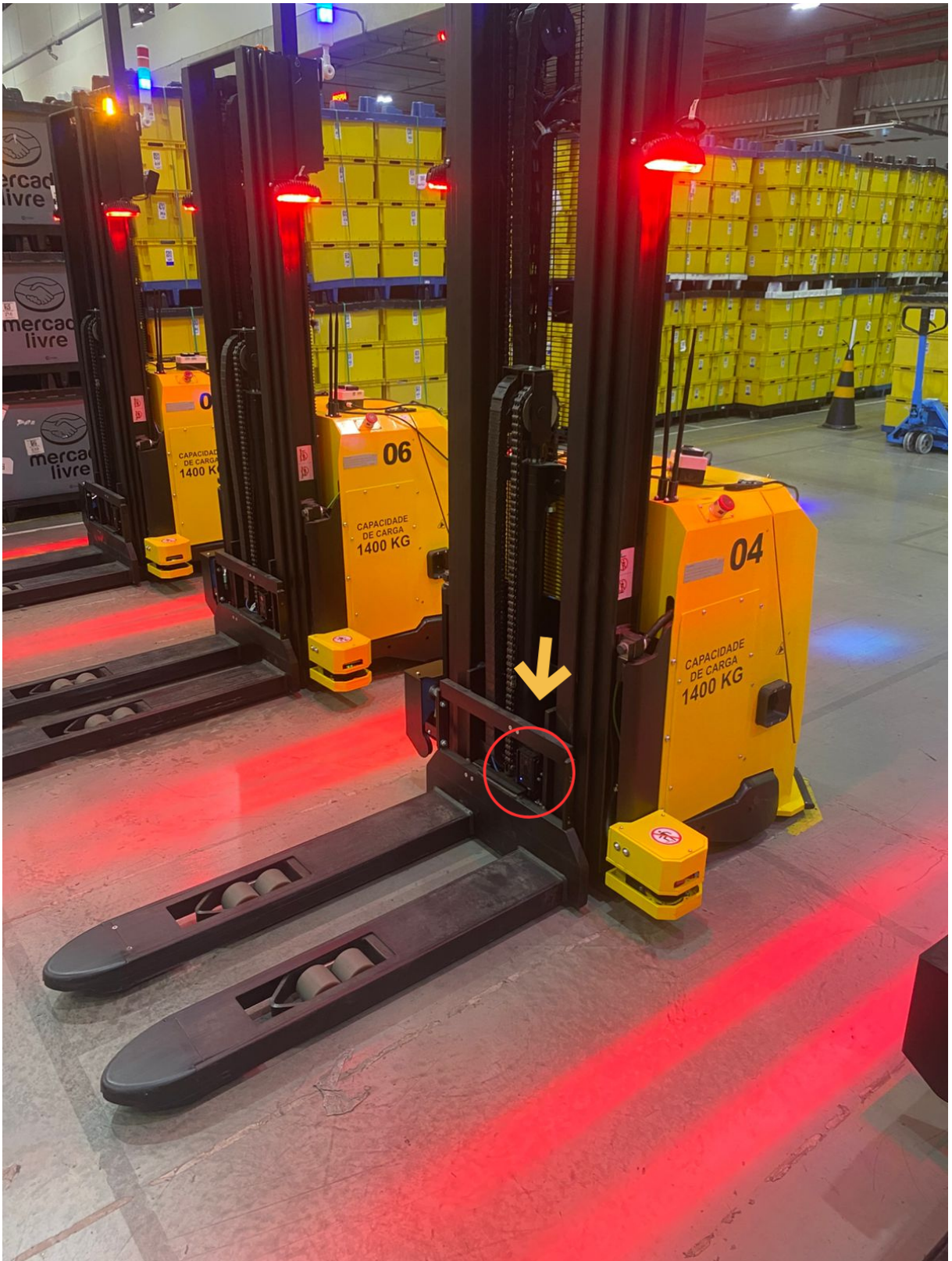
Figura 3.3: Posicionamento da câmera MRDVS no AGV: instalada centralmente acima dos garfos, orientada perpendicularmente ao solo para maximizar a precisão da segmentação e da profundidade. (Foto produzida pelo autor.)
